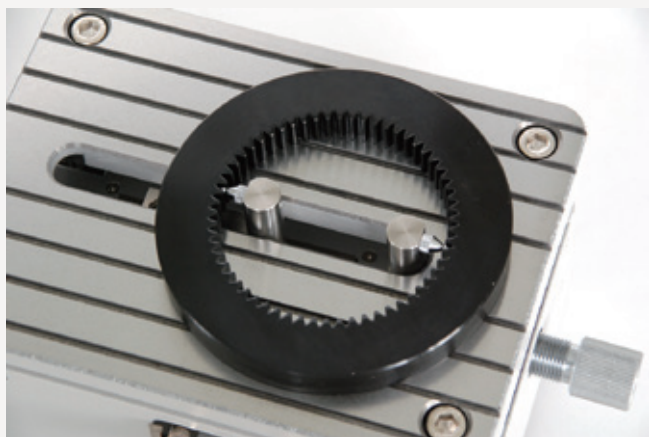
く 内歯車のオーバーピン径測定
